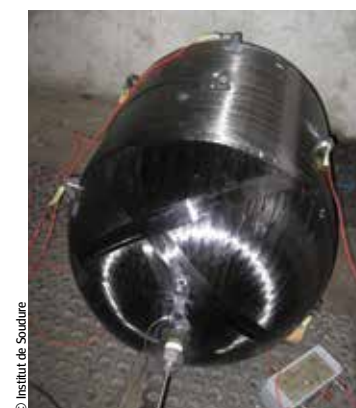
↑ Pour tester la bouteille composite, l'IS propose un contrôle acoustique.
