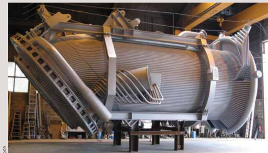
SCCM est spécialisée dans les équipements thermiques et mécaniques intervenant dans des process à haute température. Ici, une hotte convertisseur let.
